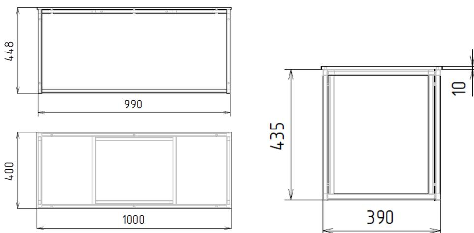
1.2. Описание: материал: пластик высокого давления HPL, толщиной 10 мм. Напольная установка: стальная разборная профильная рама, толщина профиля 20x20 мм. Рама окрашена эпоксидной порошковой краской серого цвета.
